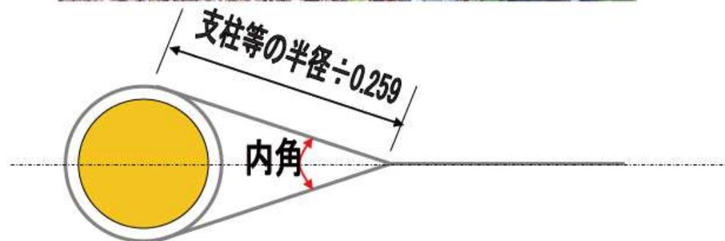
内角は $30^\circ$  以内に=100%以上の(規格)荷重で破断
